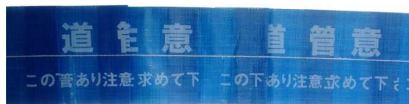
図7-3-2 管明示シートの例
