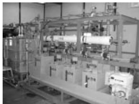
汚染の可能性のある地下水・伏流水についても対策を行う必要があり、現在、三野浄水場や牟佐浄水場においてクリプトスポリジウム対策に高い信頼性を持つ膜ろ過処理の実験を行っているほか、クリプトスポリジウムの不活性化に有効であると思われる紫外線照射による処理を検討しています。
