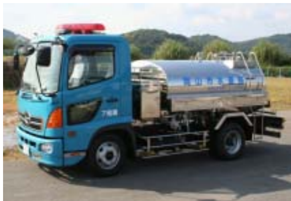
新たに導入した給水ローリー車(4トン)
