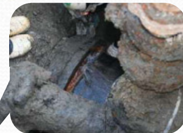
老朽継手からの漏水(石綿管)
